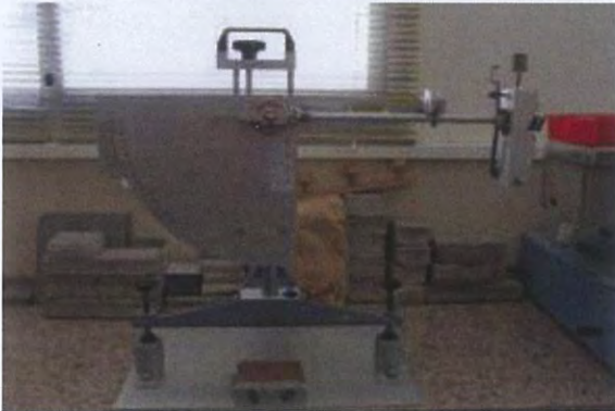
Figura 3. Equipo utilizado para realizar el ensayo de deslizamiento
